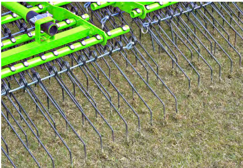
Der Striegel öffnet die Grasnarbe und lockert Schnittgutreste sowie abgestorbene Pflanzenreste
